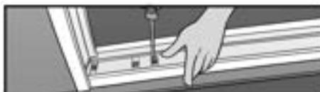
Reapertar delicadamente com chave de fenda todos os parafusos aparente dos fechos, fechaduras ou puxadores e roldanas responsáveis pela folga do caixilho de correr junto ao trilho;
