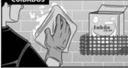
A limpeza e lavagem dos revestimentos poderão ser feitas com sabão em pó neutro utilizando pano úmido ou esponjas com cerdas macias;
