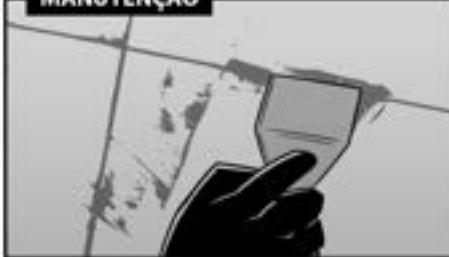
Inspecionar e completar o rejunte convencional a cada ano, e no caso de rejuntamento com PU verificar a cada 2 anos. Isso se faz importante para evitar o surgimento de manchas de carbonatação;
