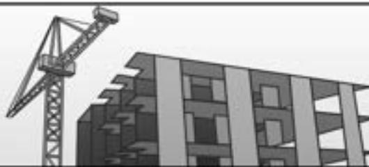
É construída por elementos que garantem a estabilidade e segurança da construção, conjunto de elementos, vigas, lajes e pilares, que formam o esqueleto de uma obra e sustentam as paredes, telhados, forros, revestimentos e instalações, além das cargas de ocupação da edificação.
