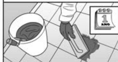
Verificar se existem peças soltas ou trincadas e reassentá-las imediatamente com argamassa colante e rejunte adequado.
