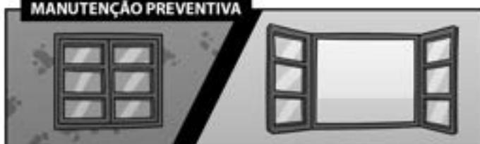
Procure manter os ambientes bem ventilados, nos períodos de inverno ou de chuva, pois podem ocorrer o surgimento de mofo nas paredes decorrentes de condensação de água por ventilação deficiente, principalmente em ambiente fechado;
