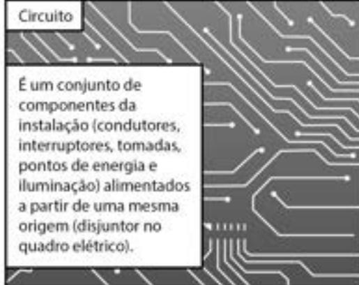
É um conjunto de componentes da instalação (condutores, interruptores, tomadas, pontos de energia e iluminação) alimentados a partir de uma mesma origem (disjuntor no quadro elétrico).
